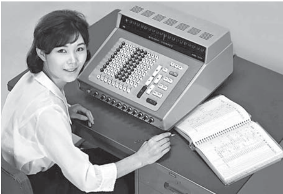
世界首台全晶体管台式电子计算器“Compet”〈CS-10A〉
