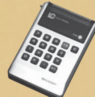
1973年／EL-805 显示器采用液晶，LSI采用C-MOS，只需一节五号电池即可使用100小时
