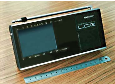
试制出的3.2英寸TFT液晶彩色电视机（1985年）
