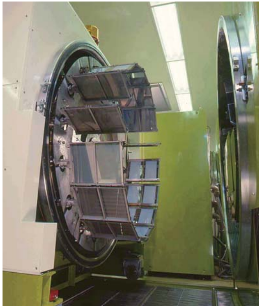
高温下对玻璃基板进行真空蒸发镀膜处理的EL平板蒸发镀膜装置
