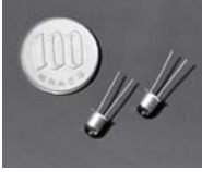
可同时发射近红外光和可视光的双色发光二极管
