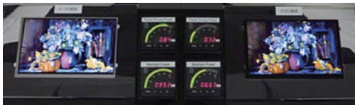
能够实现耗电比原来产品更低的IGZO液晶（右）
