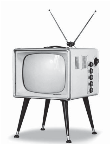
手提式电视机（TM-20） 这是一种将频道按钮全部设置在侧面的新颖款式
