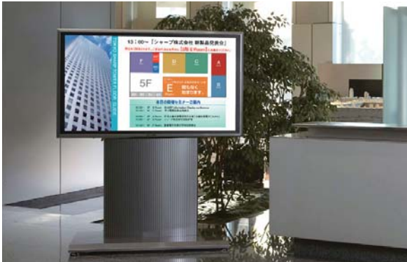
采用65英寸全规格高清液晶面板（1,920×1,080像素）的信息显示屏〈PN-655〉
