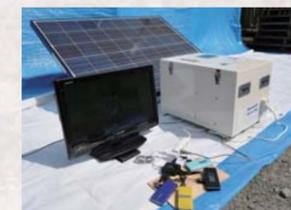
支援の一つ、太陽電池と蓄電池を組み合わせた、被災地向けソーラー発電システム。新神戸電機株式会社と共同で製作し、緊急避難場所へ寄贈。太陽光で発電した電力を蓄電池で充電し、携帯電話の充電や液晶テレビの視聴などができた
