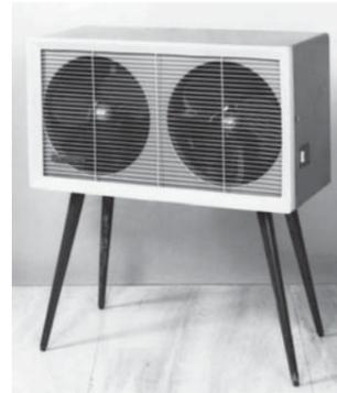
売した水冷式クーラーの仕組みは、ポンプでくみ上げた冷たい地下水を冷媒にして涼風を送り出すもので、コンプレッサーを使用しないため、運転中も振動や音が発生せず、静かなことが特長だった。
