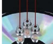
独自構造で長寿命化に成功した半導体レーザー素子
