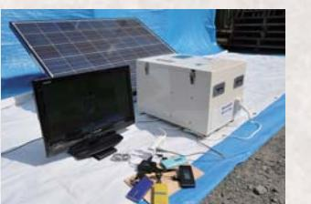
支援の一つ、太陽電池と蓄電池を組み合わせた、被災地向けソーラー発電システム。新神戸電機株式会社と共同で製作し、緊急避難場所へ寄贈。太陽光で発電した電力を蓄電し、携帯電話の充電や液晶テレビの視聴などができる
