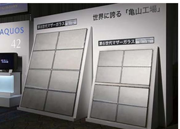
第1工場の第6世代(右)と2006年8月稼動の第2工場の第8世代マザーガラス(左)
