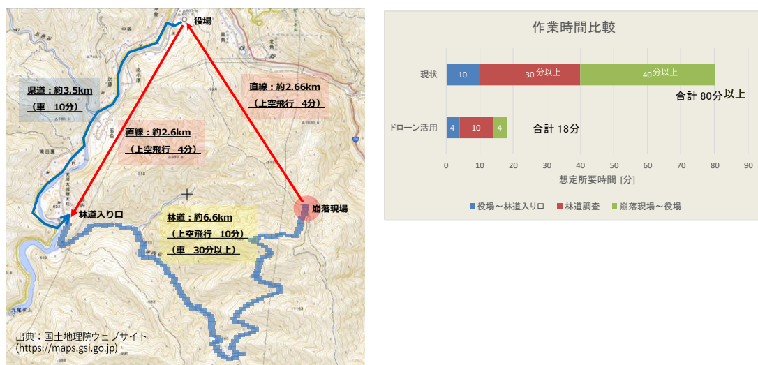
図 2.1-33 災害現場の作業時間（林道沿いの調査の場合）
