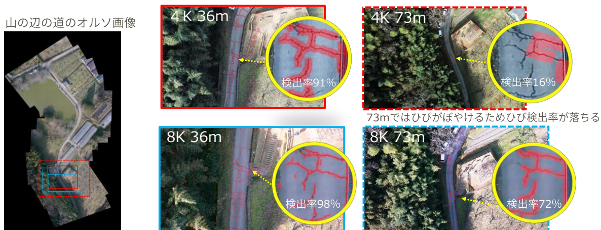
図 2.1-80 道路検査のひび検出
