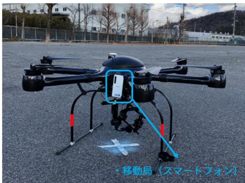
図 2.1-7 ローカル 5G 移動局を取り付けたドローン
