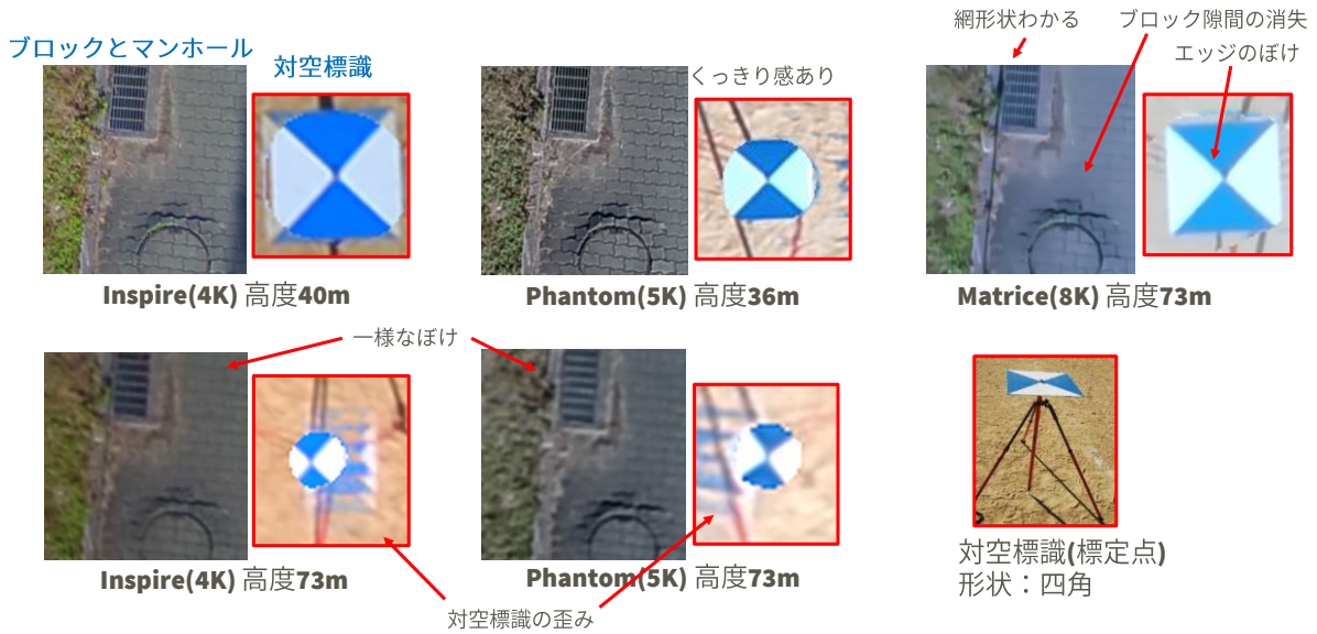
図 2.1-71 公共測量のオルソ画像の拡大比較
