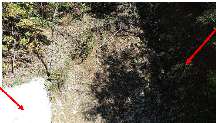
Phantom 4 Kカメラ（未編集画像） 高諧調・低諧調側で情報ロスが発生
