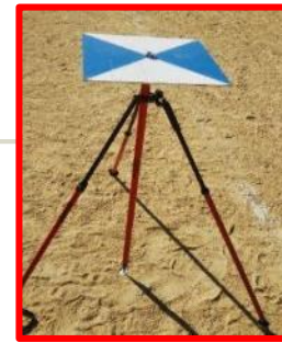
対空標識(標定点) 形状：四角
