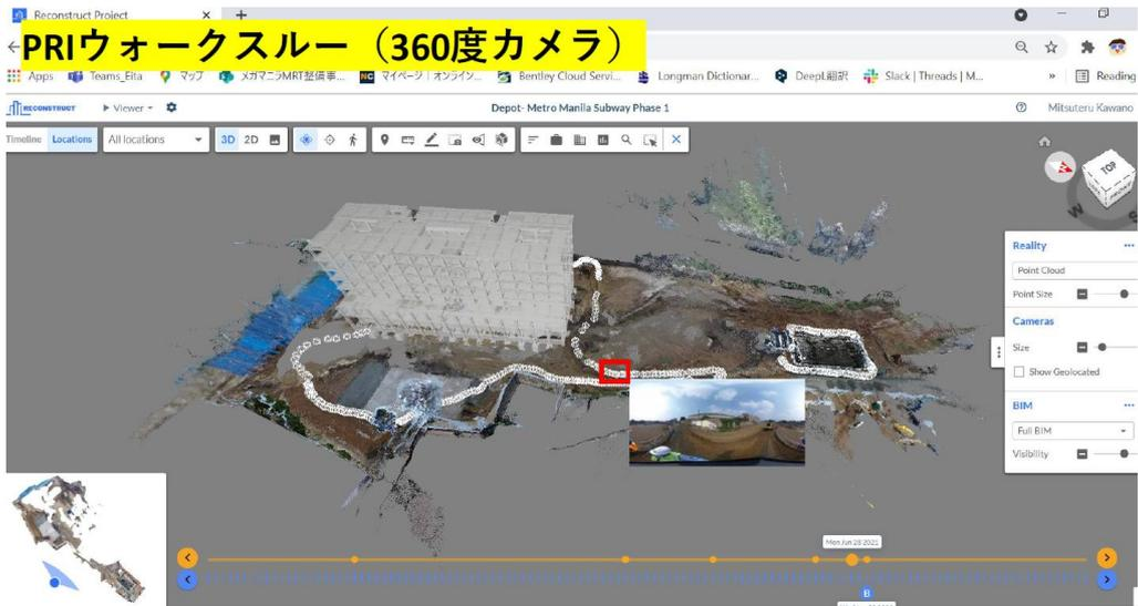
図 1.1-4 点群データと 3D モデル、現地進捗写真との属性付けによる施工管理
