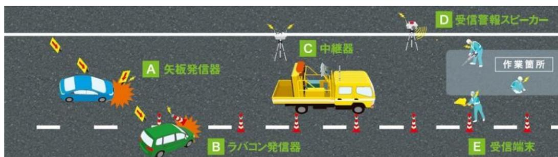
図 4.4-95 交通規制注意喚起システムの概要
