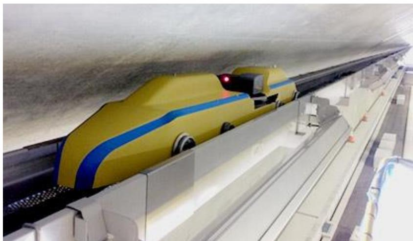
図 4.4-94 自走式カメラロボット
