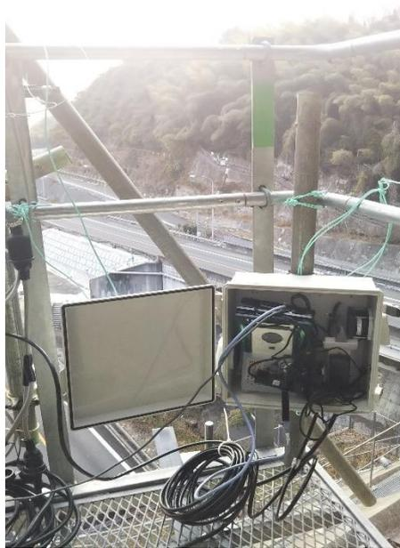
図 2.2-21 カメラオプション収納側ハウジングケース
