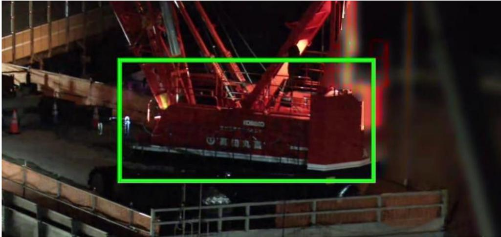
図 4.4-12 建設機械(クレーン本体部)検出結果例
