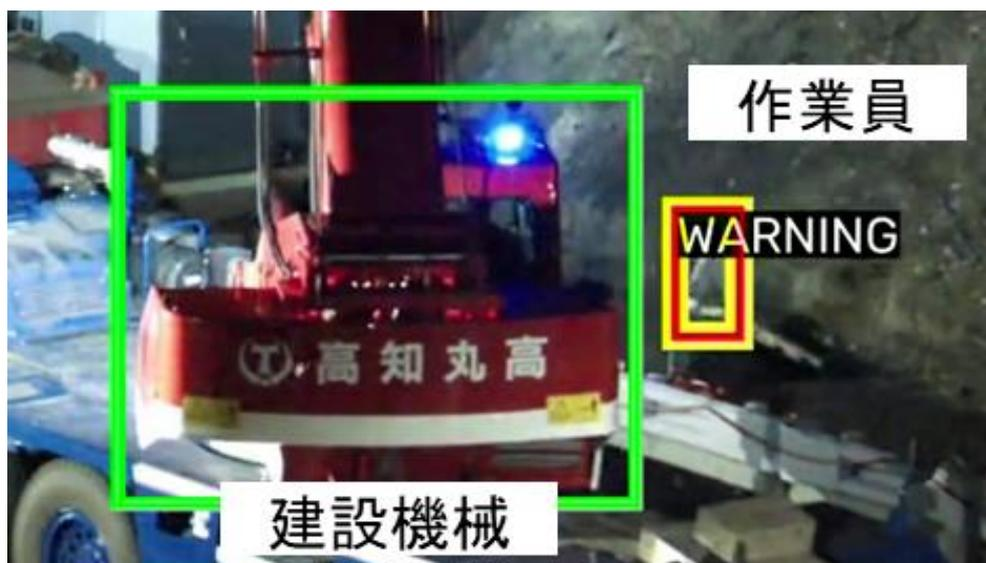
図 4.4-15 作業員と建設機械近接時の警告表示例
