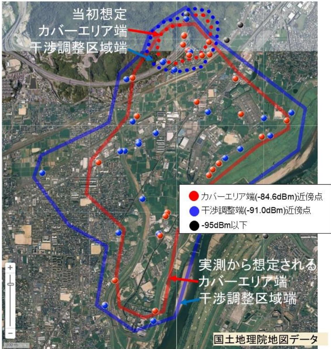
図 3.3-20 実測から想定されるカバーエリアおよび干渉調整区域
