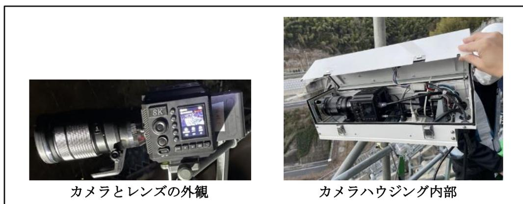
図 4.4-6 設置した 8K カメラ概要
