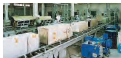
枚方プラントの冷蔵庫解体ライン
