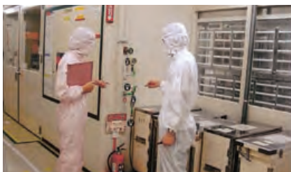
消火器など常設備品類の固定位置や、配管の開閉を明示し確認しています。
