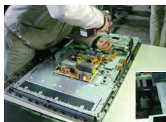
液晶电视的拆解试验
