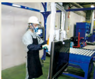
减轻操作人员作业负担的 大画面薄型电视机“运载装置”
