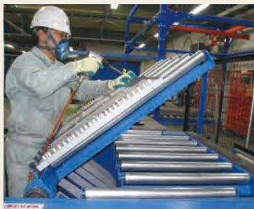
可以轻松拆卸螺钉和进行翻转等作业的“倾斜、翻转工作台”
