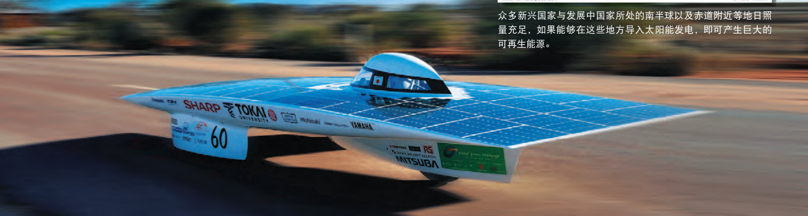
纵贯澳大利亚大陆的太阳能车拉力赛“全球绿色挑战赛”中，搭载夏普化合物太阳能电池(电池片转换效率为30%)的日本东海大学队“东海挑战者号”赛车，在约3,000公里的赛程中驶出了平均时速超过100公里的速度，最终夺冠！（2009年10月）
