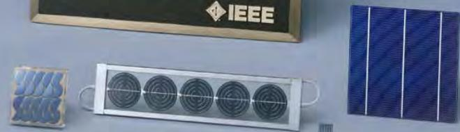
IEEEマイルストーンの銘板(左後)と手前左から灯台用単結晶モジュール2点(1966年および1978年に「尾上島灯台」設置)と宇宙用単結晶セル(1976年実用衛星「うめ」搭載)、そして住宅用多結晶セル
