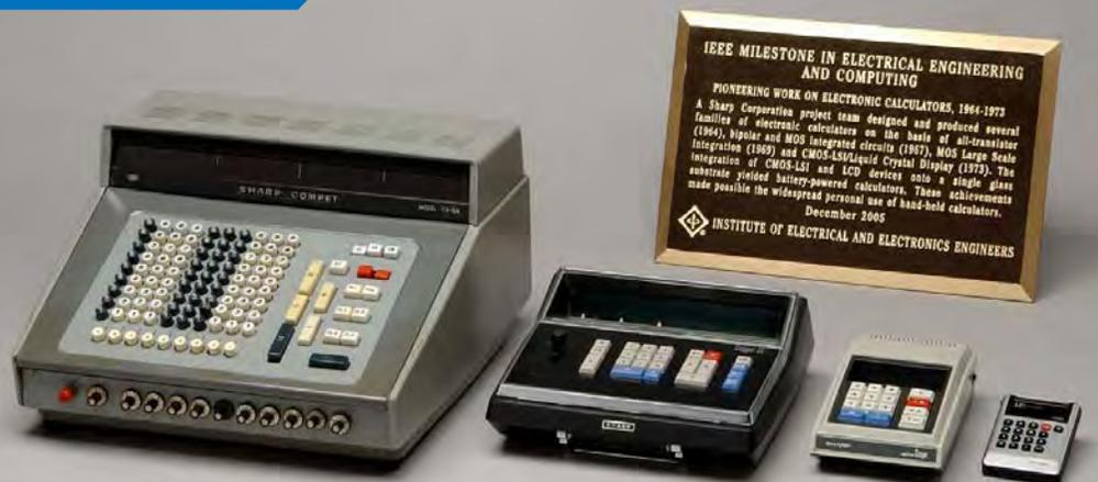
IEEEマイルストーンの銘板(右後)と、小型化、低消費電力化に対する革新的取り組みが高く評価されたシャープの電卓。左からオールトランジスタ電卓CS-10A、IC電卓CS-16A、LSI電卓QT-8D、液晶ポケット電卓EL-805
