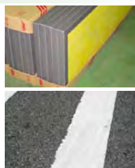
ガラス端材を断熱材(上)や道路の車線の表示材に有効活用
