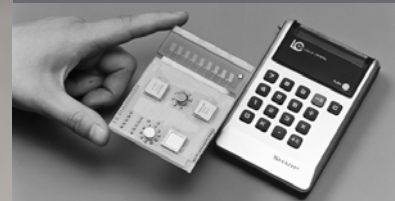
液晶ポケット電卓EL-805(1973年) 単3電池1本で100時間使用可能。1枚のガラス基板上に液晶、LSI、配線などを集約し、大幅に小型化。
