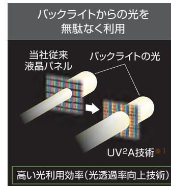
当社従来技術では、液晶セル内の構造物のために、光の漏れや妨げが発生し、光の透過率(開口率)を下げる要因になっていました。「UV<sup>2</sup>A技術<sup>※1</sup>」はこの構造物をなくすことに成功。光漏れを少なくすることで、高コントラストを実現。同時に開口率をアップし、バックライトの電力も抑制でき、低消費電力化を実現しました。
