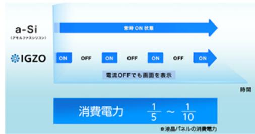
当社の従来型液晶ディスプレイ (a-Si) と IGZO 技術搭載の液晶ディスプレイとの消費電力比較
