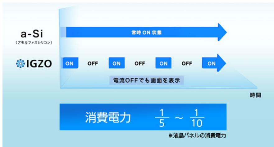
2012年11月には、世界で初めてスマートフォンにIGZO技術を搭載しました（株式会社NTTドコモ向け「docomo NEXT series AQUOS PHONE ZETA SH-02E」）。従来機と比較して、連続静止画表示時間は約4.8倍、連続動画再生時間は約2.8倍<sup>\*1</sup>の電池持ちを実現しています。
