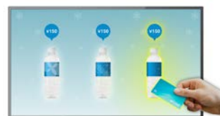
透明NFC（近距離無線通信） アンテナ搭載ディスプレイ
