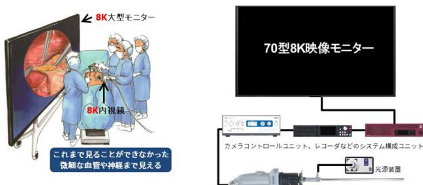
8K硬性内視鏡のイメージと構成図
