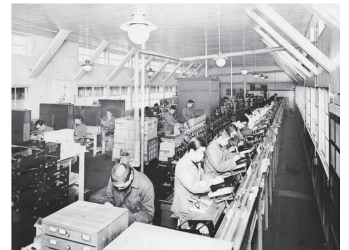
間歇式コンベアによるラジオ生産ライン(1936年ごろ)
