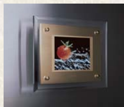
1991年 / 9E-HC1 8.6型TFT方式カラー 液晶パネル搭載
