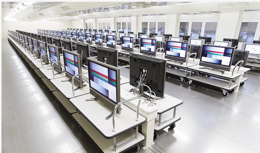
大型液晶テレビ生産ライン(恒温動作試験工程)
