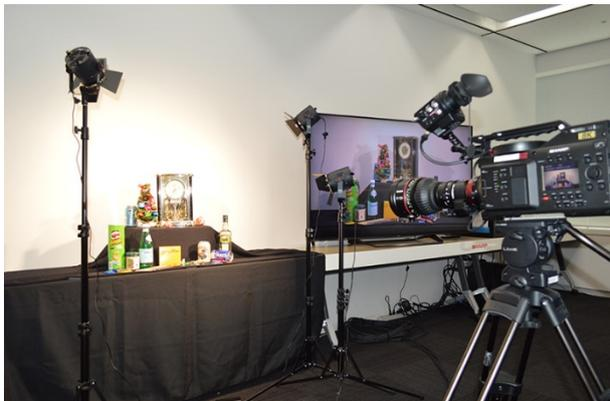
当社の8Kカムコーダーを中心とした撮影ブース。カムコーダーを移動させれば、コンテンツとして使える屋外の風景も撮影可能です。撮影した映像は、圧縮・復元処理を経てライブ映像として8Kディスプレイに表示されます。
