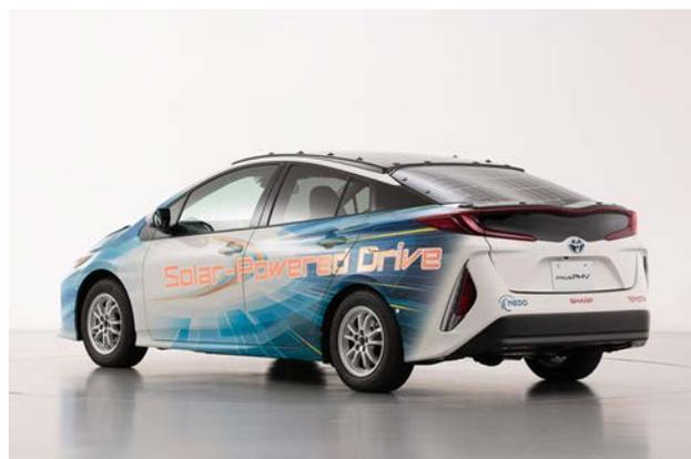
図1 太陽電池パネルを搭載した「プリウスPHV」実証車
