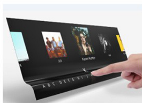
新しいタッチUIを実現する フレキシブル有機ELディスプレイ
