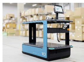
物流倉庫向けピッキングソリューション・ ピッキング支援搬送ロボット/集中制御システム<XF-ZZ242/AOS>
