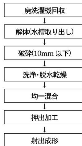
図5 リサイクル材料の調製プロセス
