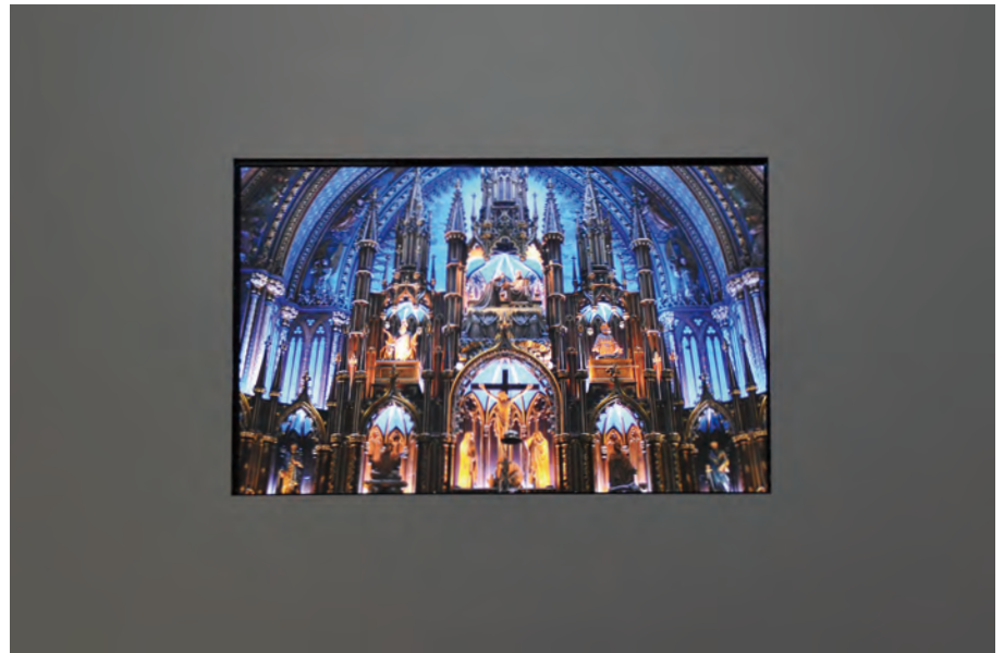
図5 6.1型超高精細498ppi液晶ディスプレイ (2560×1600ドット)
