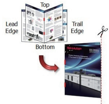
図2 天地ふちなし印刷 Fig. 2 Edge-to-Edge Printing.
