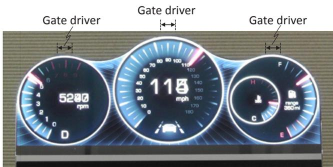
図7(b) 異形ディスプレイ試作パネル (12.3型)
