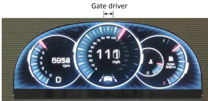
図7(a) 異形ディスプレイ試作パネル (12.3型)
