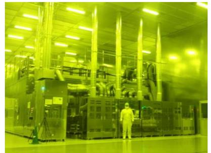
図 露光装置
