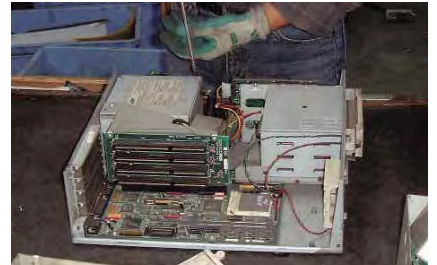
回収したパソコンの解体
