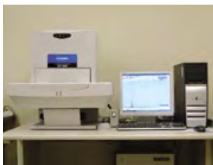
非破壊で元素分析可能なX線分析顕微鏡
