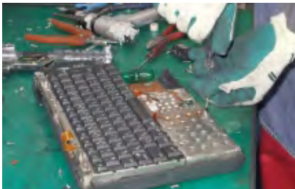
回収したパソコンの解体
