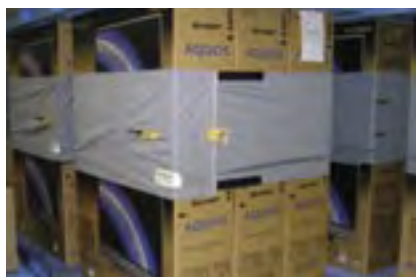
可以反复使用的货物防塌捆扎带
