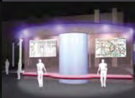
⑨ 发光太阳能电池“Lumiwal”以及展示其用途形象的草图。薄膜透明式，白天可一边采光一边用太阳能发电，夜晚则令LED发光，可用作照明。
