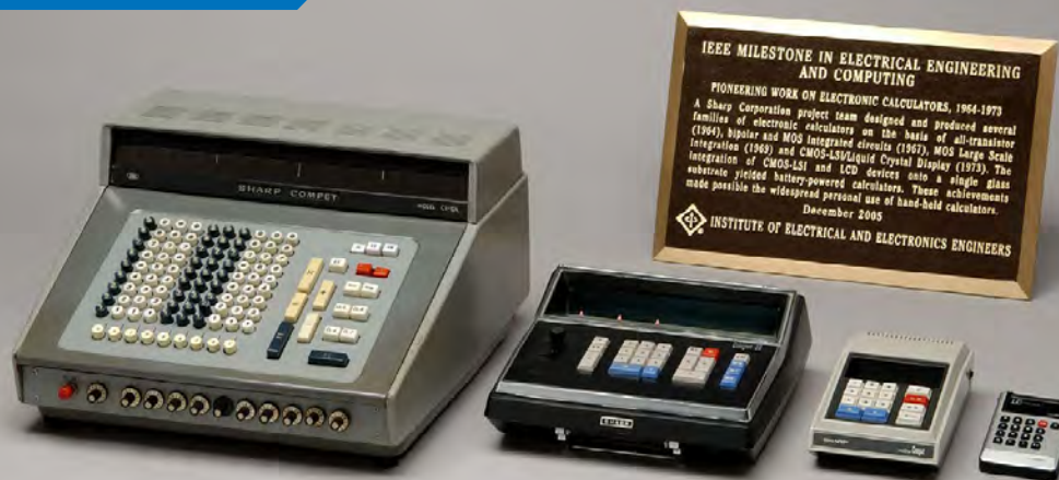
“IEEE里程碑”奖牌(右后)和因小型、低耗电的革新举措获得高度评价的夏普电子计算器。前排左侧起分别为全晶体管计算器CS-10A、IC计算器CS-16A、LSI计算器QT-8D和便携式液晶计算器EL-805
