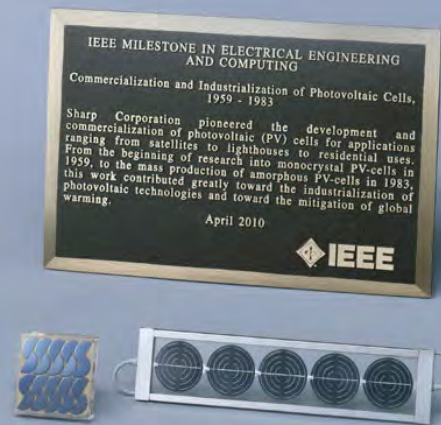
“IEEE里程碑”奖牌(左后),前排左起分别为灯塔用单晶硅模组2件(1966年及1978年先后安装在“尾上岛灯塔”上)、宇航用电池片(1976年搭载在实用型卫星“UME”号上)以及住宅用多晶硅电池片
