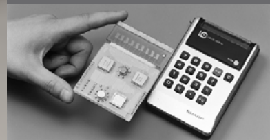
便携式液晶计算器EL-805(1973年)使用1节5号电池便可工作100小时。将液晶、LSI以及布线等集成在一块玻璃基板上,大幅度地实现了小型化。
