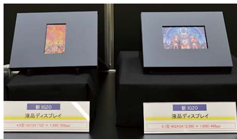
搭载氧化物半导体IGZO技术的液晶显示器
