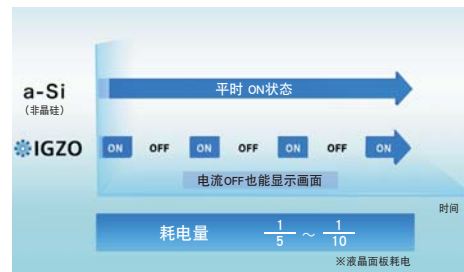
夏普以往的液晶显示器(a-Si)与搭载IGZO技术的液晶显示器的耗电比较
