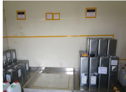
危険物保管場所の容器の積み上げ基準を黄色のラインで明確化
