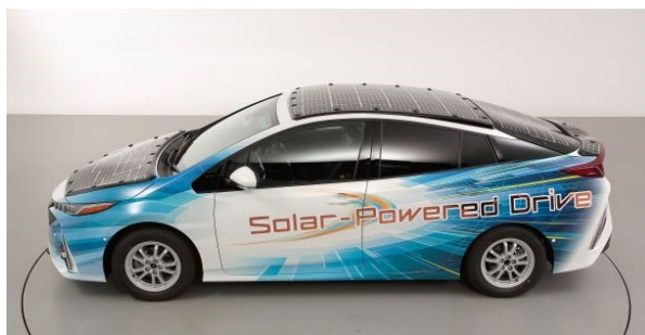
太陽電池パネルを搭載した「プリウスPHV」実証車
