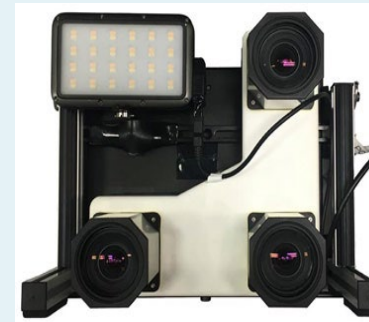
3眼カメラ配筋検査システム
