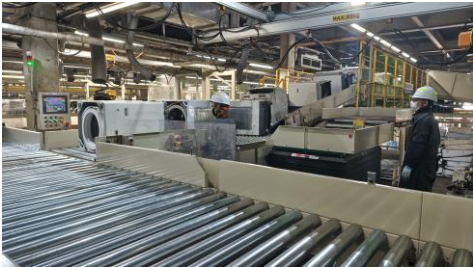
洗濯機搬送ライン
