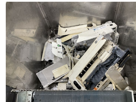
切断後の室内機
