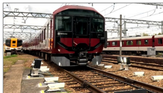
車両床下検査システム実証実験
