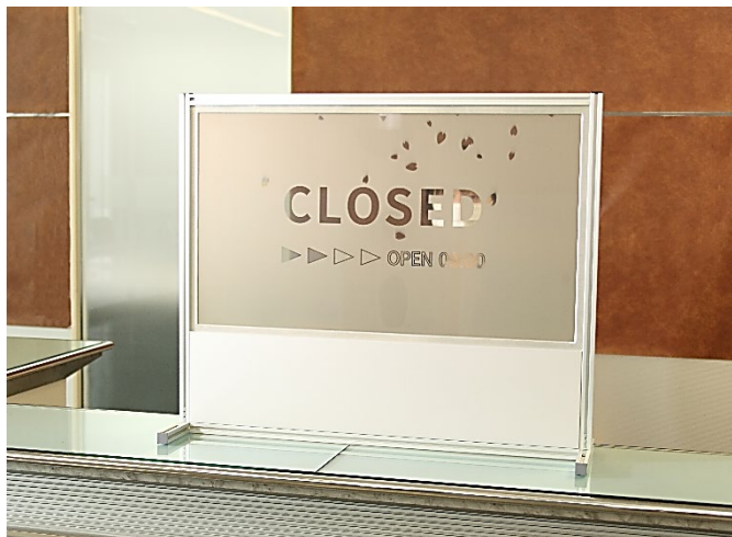
31.5V型 (横約700mm×縦約400mm) の透明ディスプレイを搭載したパーティション
