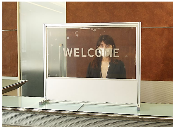
31.5V型 (横約700mm×縦約400mm) の透明ディスプレイを搭載したパーティション
