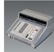
世界初、オールランジスタ・ダイ オードによる電子式卓上計算機 "コンペット"
