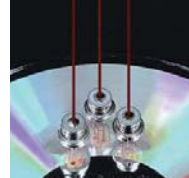
独自構造で長寿命化に成功した 半導体レーザー素子
