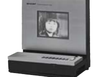
高輝度、長寿命の薄膜EL素子 でテレビ映像再生に成功 (写真は1977年のもの)
