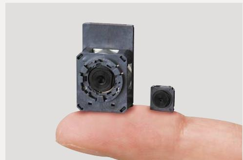
携帯電話用CCD・CMOSカメラモジュール
