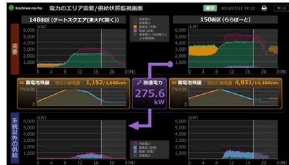
各施設のエネルギー需給量と電力融通量を把握する画面
