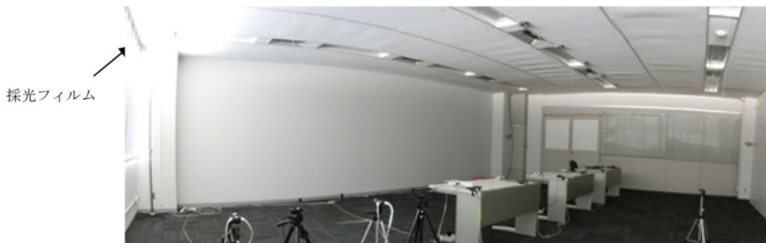
(図1：窓から1m間隔に照度計を設置した実験室)
