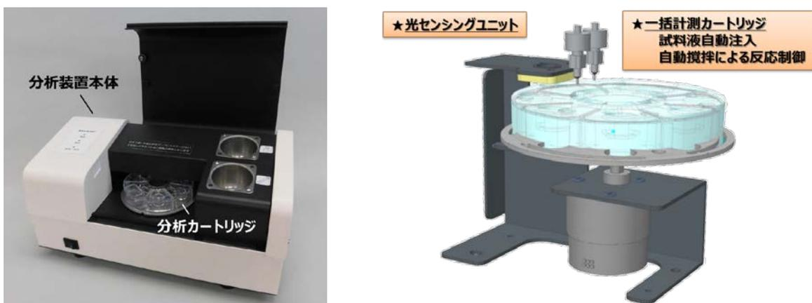
独自のカートリッジシステムによる6種類の土壌養分一括計測
