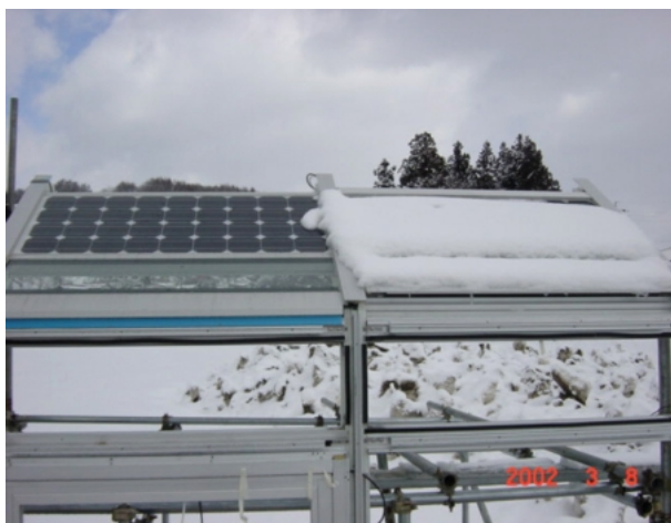
写真5 枠無し太陽電池モジュール（左）と枠有り太陽電池モジュール（右） Photo 5 Solar module without frame (left) and with frame (right).
