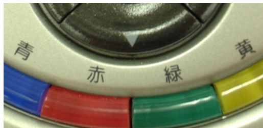
図6 カラーキーの文字による表記 Fig. 6 Character notation of color button.
