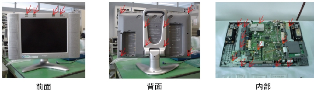
図6 易解体製品（液晶テレビ） Fig. 6 Prototype of Easy-release product (LCD TV).
