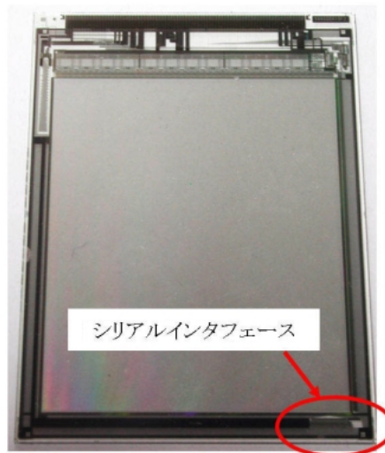
図6 シリアルインタフェース内蔵システム液晶パネル Fig. 6 System LCD Panel with a Serial Interface.
