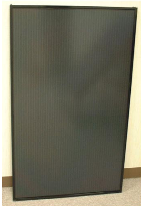
図4 大面積薄膜シリコン太陽電池モジュールの外観写真とI-V, P-V 特性 (初期値)
