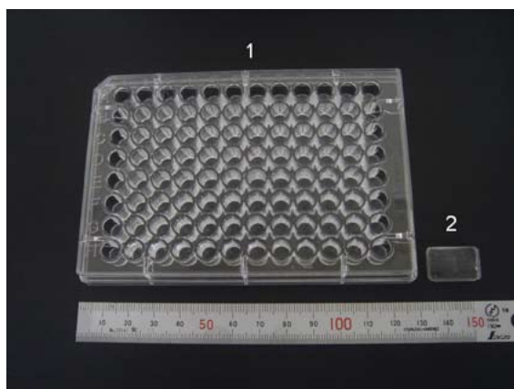
図1 マイクロタイタープレート1 (125 × 5 × 15mm) とPDMSマイクロチップ2 (20 × 12 × 3mm)
