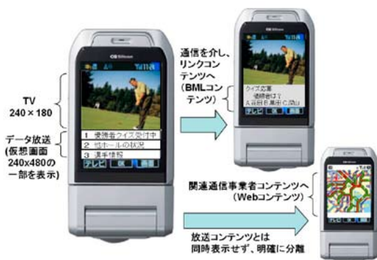
図8 データ放送から通信によるアクセスへの様子 Fig. 8 Access through communication network from the data broadcasting.
